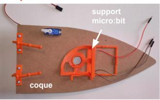
2 - Effectuer les raccordements électriques entre le support carte micro:bit, le servomoteur et le support de piles pour servomoteur
